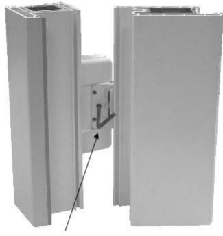
Stufenlose Dichtungs-Andruck-Regulierung: Bei geöffneter Tür mit einem Imbusschlüssel SW 4 den Andruck verringern (-) oder erhöhen (+). Der Andruck lässt sich bis zu 5 mm verändern.
