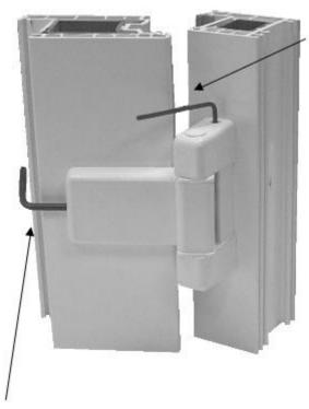
Stufenlose Höhenverstellung: Ziernippel entfernen und mit einem Imbusschlüssel SW 3, die gewünschte Höhenregulierung vornehmen. Eine Umdrehung = 1 mm Veränderung Maximale Veränderung = 7 mm
