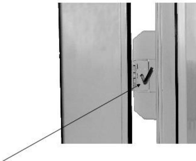
Stufenlose Dichtungs-Andruck-Regulierung: Bei geöffneter Tür mit einem Imbusschlüssel SW 4 den Andruck verringern (-) oder erhöhen (+). Der Andruck lässt sich bis zu 5 mm verändern.
