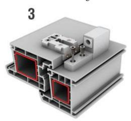
3. Blendrahmenteil mit werkseitig gelieferten Schrauben befestigen.
