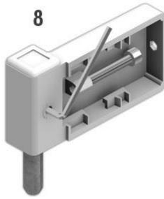
**8.** Durch Einsetzen einer Sicherungsschraube wird der Achsstift blockiert. Diese Sicherung ist nur bei nach außen öffnenden Türen notwendig. Zur eventuellen Andruck-Regulierung muss die Sicherungsschraube zwischenzeitlich entfernt werden.
