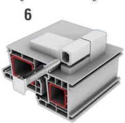
**6.** Spezial-Achsstift mit voreingestelltem Andruck mit Kunststoffhammer bis zum Anschlag eintreiben.
