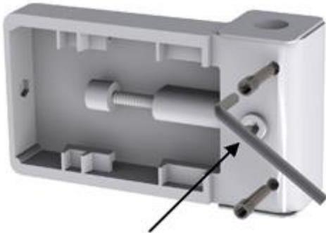
8. Sicherungsschraube einsetzen
