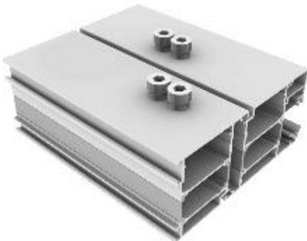
**2. Danach die Secofixschrauben oberflächenbündig eindrehen.**
