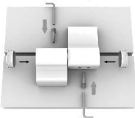
**8.** Mit den Kegelschrauben dem Türband einen festen Sitz geben! (stark anziehen) Die zwei Verschlusskappen einsetzen.
