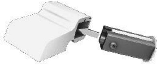
**5.** Lagerbuchse in Flügelteil einschieben (DIN links/rechts).
