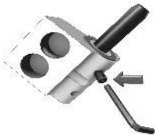
**4. Mit Gewindestift M6x8 mm die Höhenverstellung sichern (Höhe ist auf „0“ eingestellt)**
