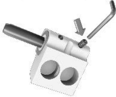
**6.** Bei auswärts öffnenden Türen die Sicherungsschraube M6 x 22mm einschrauben.
