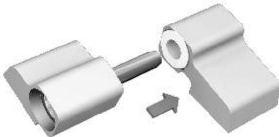
**8.** Das Türband auf Flügel und Rahmen mit den vorbereiteten Schrauben aufsetzen.
