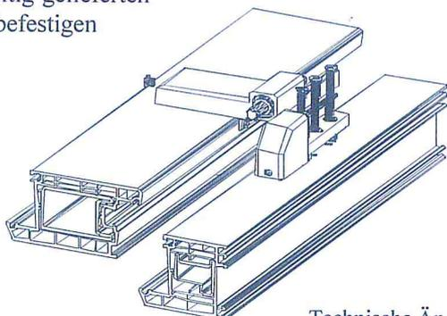
6. Flügelbandteil mit voreingestelltem Spezialschlüssel mit dem Aufnahmebock verbinden. Der Spezialschlüssel klinkt automatisch aus, sobald der eingestellte Wert erreicht ist.
