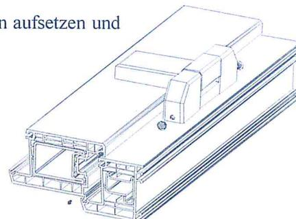
10. Durch Verstellen der Andruckschraube kann der Andruck stufenlos verstellt werden.
