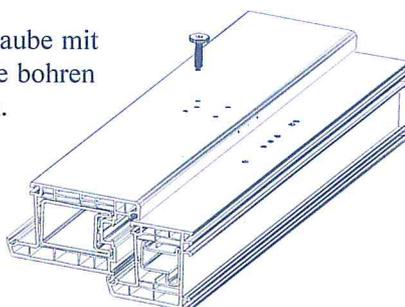
3. Aufnahmebock für Flügelbandteil mit werksseitig, gelieferten Schrauben befestigen.
