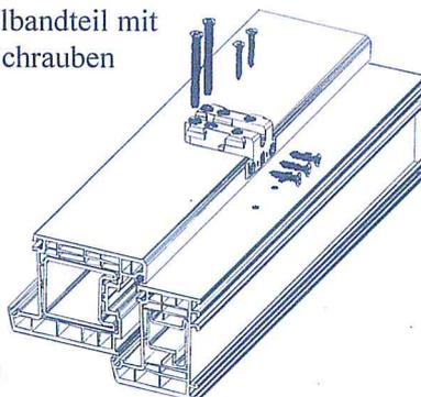
4. Bei Türen die nach außen öffnen, Gewindestift M4 x15 mm eindrehen (Einbruchssicherung).
