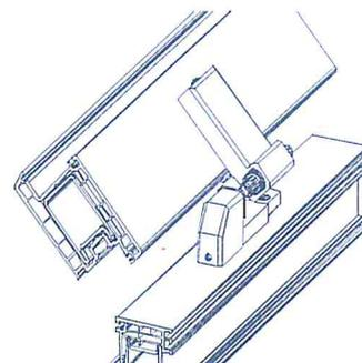
8. Unteres und oberes Blendrahmenlager mit flexiblen Schraubendreher anziehen.
