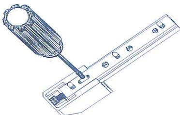
5. Führungsschiene mit Blendrahmenlager mit werksseitig gelieferten Schrauben befestigen
